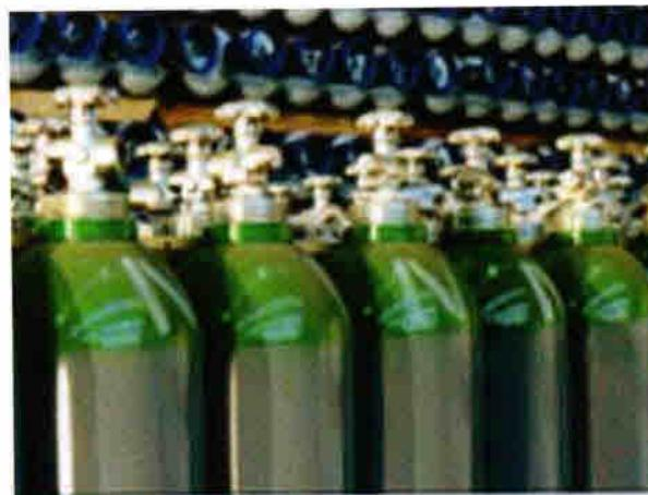
Бутилките съхраняващи компресирания природен газ са свързани в батерия за осигуряване на по-големи количества при всяка една доставка.
